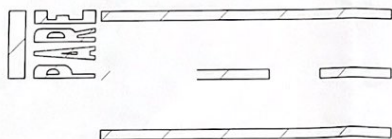
DETALHE - PINTURA DE FAIXAS
